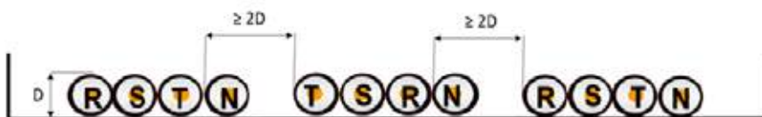
3 conductores por fase.
