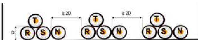
3 conductores por fase (al tratarse de numero impar obsérvese que el criterio de agrupamiento cambia las ternas no se compensan 2 a 2).
