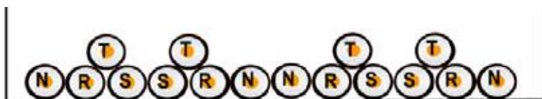
4 conductores por fase.
