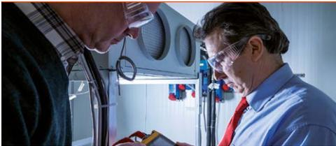
Diseñada para unidades de aire acondicionado relacionadas con el sector de las telecomunicaciones, cuenta con dos cámaras de prueba distintas: una para la simulación de condiciones ambientales interiores, con temperaturas de entre 0 y 60 °C, y otra para la simulación de condiciones ambientales exteriores, con temperaturas de entre -32 y 60 °C. El laboratorio 2 tiene capacidad para equilibrar una carga térmica de hasta 100 kW (50 kW para cada sala).
