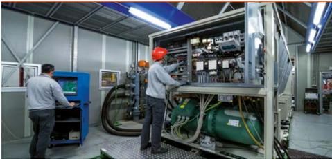
La zona de validación de enfriadores de freecooling contiene enfriadores de freecooling simples y adiabáticos. Es capaz de equilibrar una carga térmica de hasta 1.600 kW, con una temperatura del aire de la cámara de entre 20 y 50 °C y un punto de ajuste de agua del enfriador de entre 5 y 20 °C.
