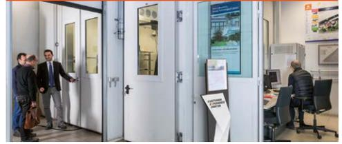
Este laboratorio responde a la creciente demanda de pruebas presenciales y homologaciones específicas de productos especiales para clientes. Equipado con una sala climática automatizada y es capaz de equilibrar una carga térmica de hasta 200 kW, y simular un entorno de prueba con un rango de temperaturas de 0 a 60 °C.
