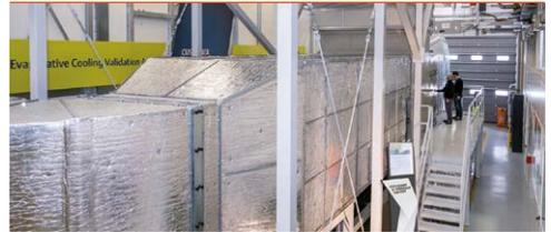
La zona está dedicada a las pruebas del Liebert EFC, una unidad de refrigeración evaporativa con freecooling indirecto de aire de alto rendimiento de Vertiv. Los parámetros de prueba incluyen cargas de TI de hasta 450 kW y un caudal de aire de hasta 120.000 m<sup>3</sup> por hora a cualquier temperatura ambiente externa necesaria para simular las condiciones ambientales típicas de la región EMEA.
