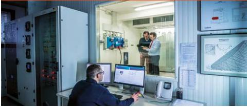
Diseñada para la ejecución de pruebas de unidades de montaje en el suelo y tiene capacidad para equilibrar una carga térmica de hasta 150 kW con una temperatura del aire de la cámara de entre 0 y 60 °C.
