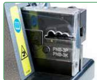
PNB-3P detalle de la zona de compresión.
