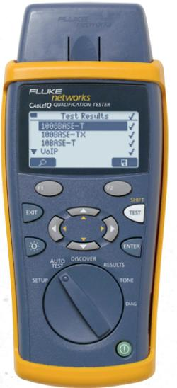
\*Use cables híbridos de RJ45 a M12 para las comprobaciones en conectores M12D y M12X con MS=POE y CIQ
